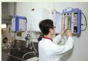
用以製造純淨水 供修復工序使用的 離子交換過濾器
