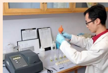
以亞甲藍法測試(Methylene Blue Test) 經沖洗後的縮微膠卷以確保品質
