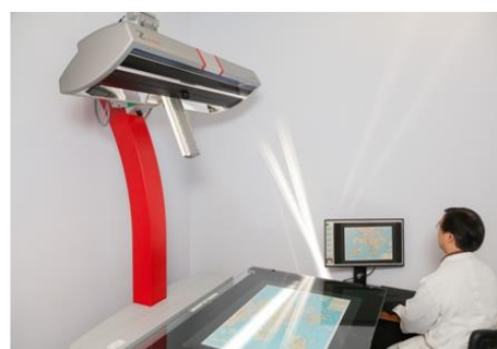
為大至A0尺寸平面檔案攝製 數碼化影像的 A0尺寸平台式掃描器
