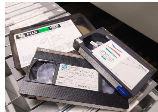
圖 1：VHS 錄影帶 (下方)、Betacam 錄影帶 (右上方) 和 U-Matic 錄影帶 (左上方)
