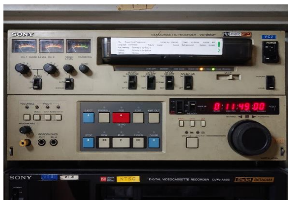
圖 2：已放入錄音帶的 U-Matic 系統
