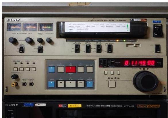
图 2：已放入录音带的 U-Matic 系统
