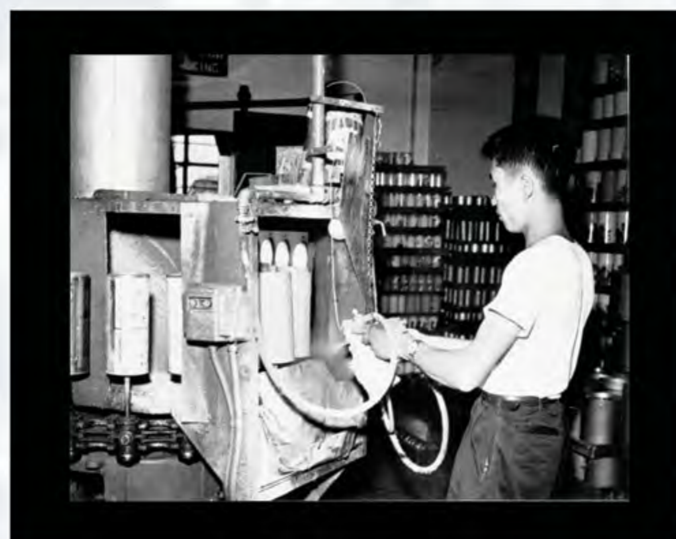
正在為暖水壺外殼進行噴漆的工序，攝於1958年。 Outer casings of flasks being sprayed (1958).
